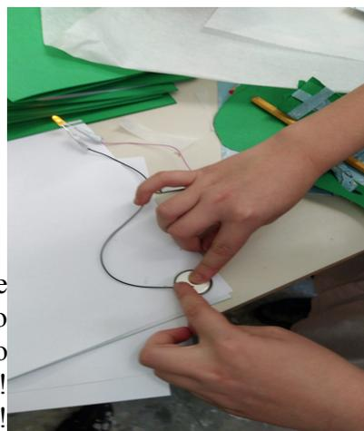
Prima di fissare il circuito con del nastro al foglio bianco, nella posizione giusta per far illuminare la stella, i bambini e le bambine hanno provato a chiudere il circuito mettendo a contatto con la parte della batteria che riporta il segno + il filo di rame legato all'ANODO.... MAGIA!!!! Evviva!!! Funziona!!! Il led si illumina!!!
